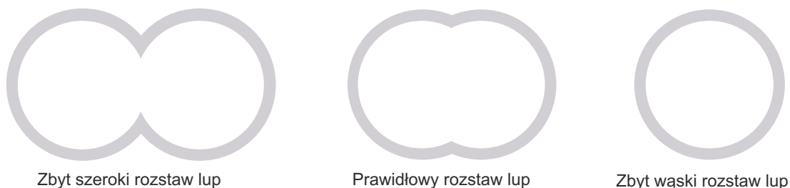
Rys. C. Obraz widziany w trakcie dostrajania rozstawu lup
